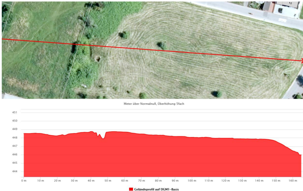
Abbildung 14: Geländeprofil von Westen nach Osten im Plangebiet bei 5facher Überhöhung. Quelle: Daten- und Kartendienst der LUBW, abgerufen am 14.11.2024.
